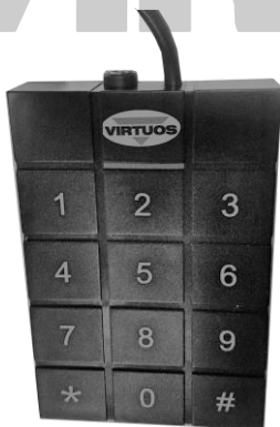
Shora je konektor na připojení napájecího adaptéru
